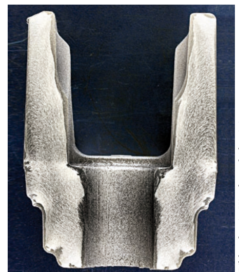
Bild 2: Bei Schmiedeteilen bildet sich beim Umformen im Material eine Faserstruktur aus. In Richtung dieser Fasern weist das Bauteil eine höhere statische und dynamische Festigkeit auf
