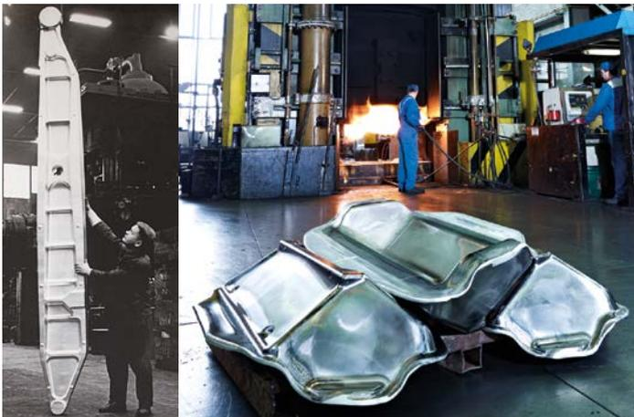
Bild 3: Fahrwerksträger der Boeing 727 (links) und 300 MN-Pressen (rechts)
