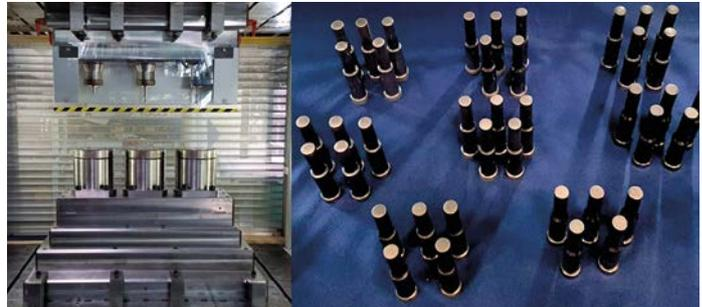
Bild 3: Versuchsaufbau zur Herstellung skaliertener Getriebewellen durch Voll-Vorwärts-Fließpressen (links) und erzeugte Wellen (rechts)
