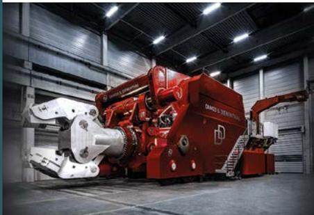
Die Schmiedemanipulatoren vom Typ SSM liefert Dango & Dienenthal ab sofort mit dem ERS-System zur Energie-Rückgewinnung.
