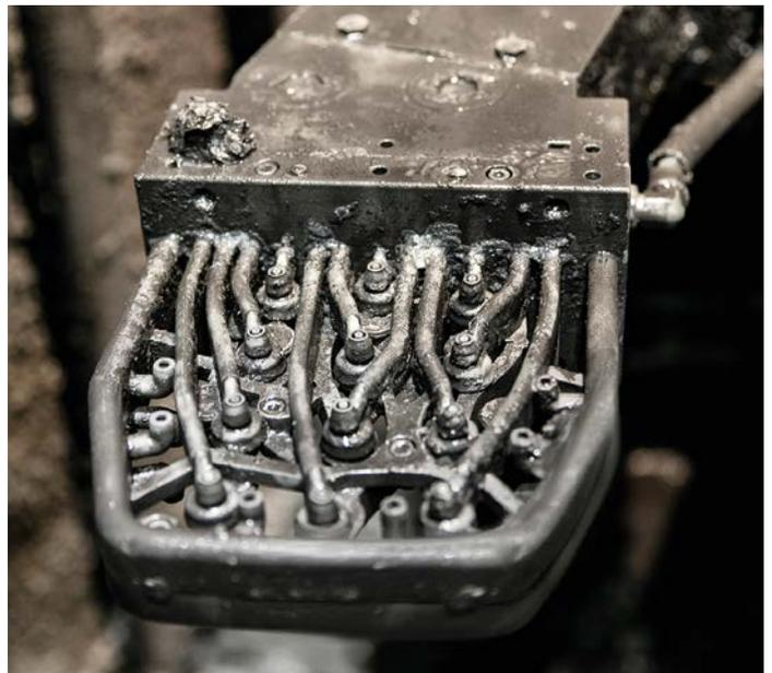
Einige Sprühköpfe wurden so ausgelegt, dass es möglich ist, Wasser und ein graphitbasiertes Sprühmittel im Wechsel zu schalten. Die Düsen selbst können ebenfalls per Schaltung verschlossen werden. Das garantiert, dass keine Flüssigkeit ungewollt entweichen kann. Alle Schaltungen werden mit Druckluft ausgelöst. Mitarbeiter sowie Betreiber waren bei ersten Einsätzen sehr zufrieden mit dem 3D-Sprühkopf.
