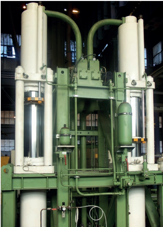
Bild 5: Transfer Barrier an einer Freiformschmiedepresse.
