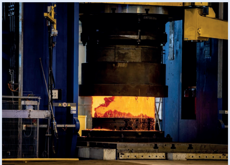
Bild 2 und 3: Beispiel einer doppelwirkenden hydraulischen Multifunktions-Schmiedepresse mit einer Presskraft von 140 MN, einer Gesamthöhe von über 30 m und einem Gewicht von über 4.500 t. Mit einem Arbeitsraum von über 6.000 mm Höhe und einer Tischfläche von über 5.000 x 5.000 m 2 ermöglicht die Presse sowohl manuelles Schmieden, Freiformschmieden als auch Automatikabläufe mittels einer durch den Bediener frei programmierbare Schrittkette.
