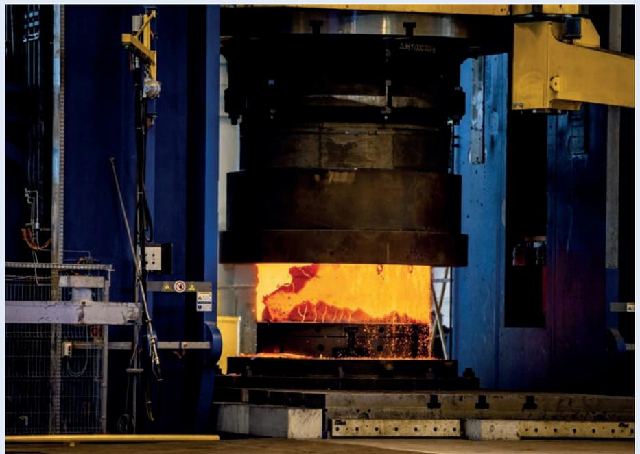
Bild 2 und 3: Beispiel einer doppelwirkenden hydraulischen Multifunktions-Schmiedepresse mit einer Presskraft von 140 MN, einer Gesamthöhe von über 30 m und einem Gewicht von über 4.500 t. Mit einem Arbeitsraum von über 6.000 mm Höhe und einer Tischfläche von über 5.000 x 5.000 m<sup>2</sup> ermöglicht die Presse sowohl manuelles Schmieden, Freiformschmieden als auch Automatikabläufe mittels einer durch den Bediener frei programmierbare Schrittkette.
