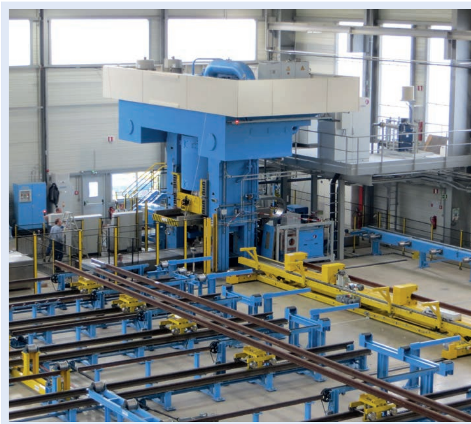
Bild 4: Vollautomatische Fertigungsanlage für geschmiedete Eisenbahnschienenprofile, die als Beispiel besondere Anforderungen an die Erstellung des Sicherheitskonzepts stellte. Der Fertigungsablauf der 5 m bis 42 m langen Eisenbahnschienenprofile für Hochgeschwindigkeitstrassen umfasst die kompletten Schritte: Erwärmung durch Induktion, Schmieden mit einer Presskraft von 50.000 kN, Wärmebehandlung, Richten, Enden-Bearbeitung, Abbrennstumpfschweißen, Polieren und Sandstrahlen sowie der vollautomatische Transport der Schienen.
