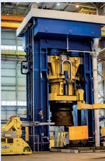
Bild 2 und 3: Beispiel einer doppelwirkenden hydraulischen Multifunktions-Schmiedepresse mit einer Presskraft von 140 MN, einer Gesamthöhe von über 30 m und einem Gewicht von über 4.500 t. Mit einem Arbeitsraum von über 6.000 mm Höhe und einer Tischfläche von über 5.000 x 5.000 m 2 ermöglicht die Presse sowohl manuelles Schmieden, Freiformschmieden als auch Automatikabläufe mittels einer durch den Bediener frei programmierbare Schrittkette.
