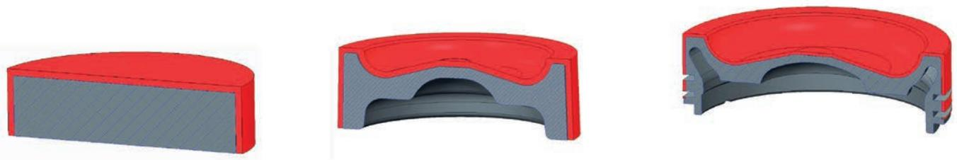
Bild 3: CAD-Modell: Werkstoffverbund-Anfangsform (links), Schmiederohteil (Mitte), Fertigteil - mechanisch bearbeitet (rechts).
