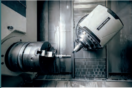
Fünf-Achs-Bearbeitungszentrum bei WTP
