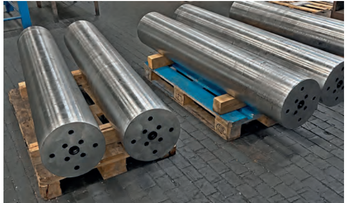
Bild 5: Rohlinge nach dem Bohren
