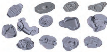
Auswahl von Bauteilen, deren Stadienfolge mit QForm UK Direct entwickelt wurde
