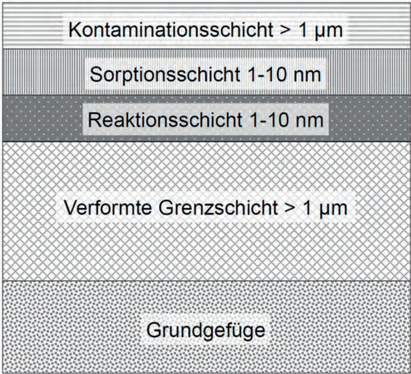
Bild 1: Schematischer Aufbau der Oberfläche metallischer Bauteile nach Haase [5]
