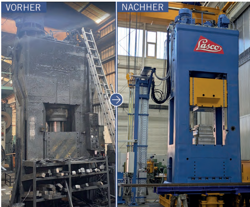
Bild 3: Bewährte Maschine in neuem Glanz: LASCO MXP vor und nach dem Retrofit. Bilder: LASCO Umformtechnik GmbH
