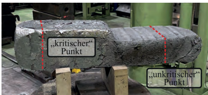
Bild 4: Kritischer und unkritischer Bereich im geschmiedeten repräsentativen Teilstück (repT)
