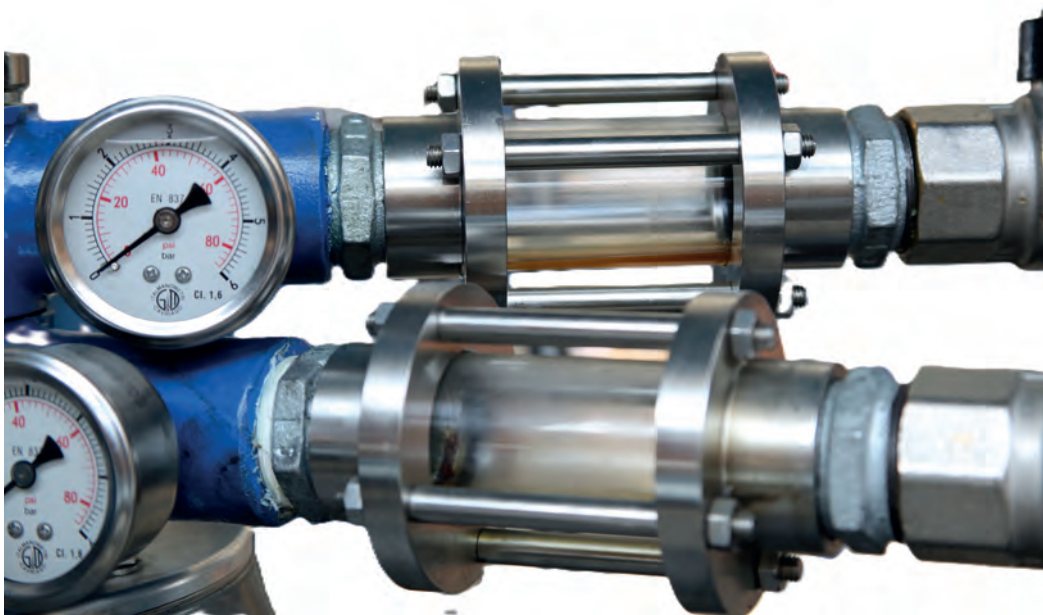
Bild 2: Haupttrennung von Öl- und Wasserphase Bilder: Hatebur
