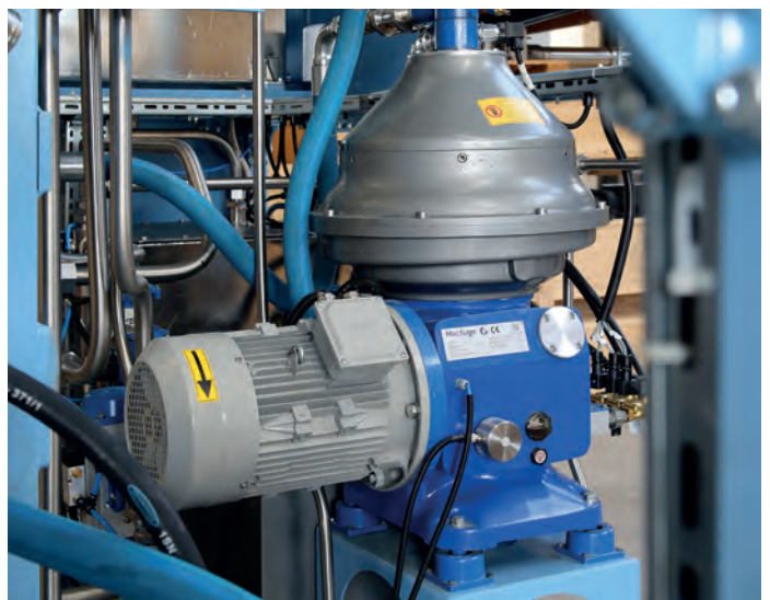
Bild 1: Eine leistungsstarke Dreiphasenzentrifuge sorgt für einen kontinuierlichen, zuverlässigen Prozess
