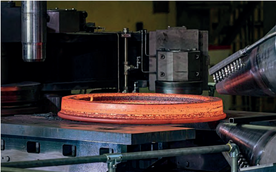
Das Oberlager der Dornwalze lässt sich in verschiedenen Höhen arretieren, Bilder: ANDRITZ Schuler
