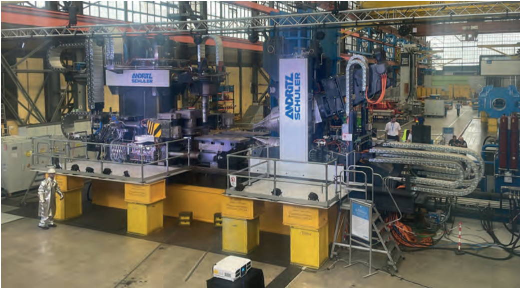
Die neu entwickelte Ringwalze kann Materialien wie Stahl, Aluminium, Titan und Nickel-Basis-Legierungen verarbeiten.
