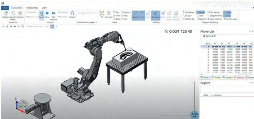
Bild 3: Automatische Bahn- und Lagenplanung
