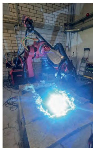
Bild 4: Roboterbasiertes/-gestütztes Auftragsschweißen Bilder: DMFG Solutions GmbH
