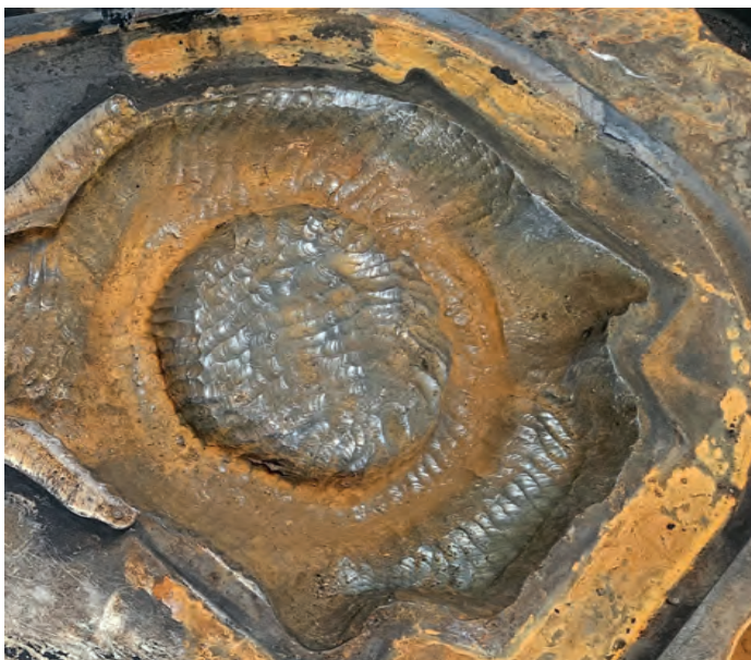
Bild 1: Darstellung eines typischen ausgefugten Werkzeugs, vorbereitet zur Regenerierung
