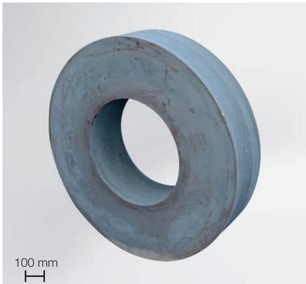
Bild 10.4: Rohteil für ein Zahnrad ( m = 1.300 \text{ kg} ) Die Prozesskette zur Fertigung ist in Kapitel 7.4 beschrieben.
