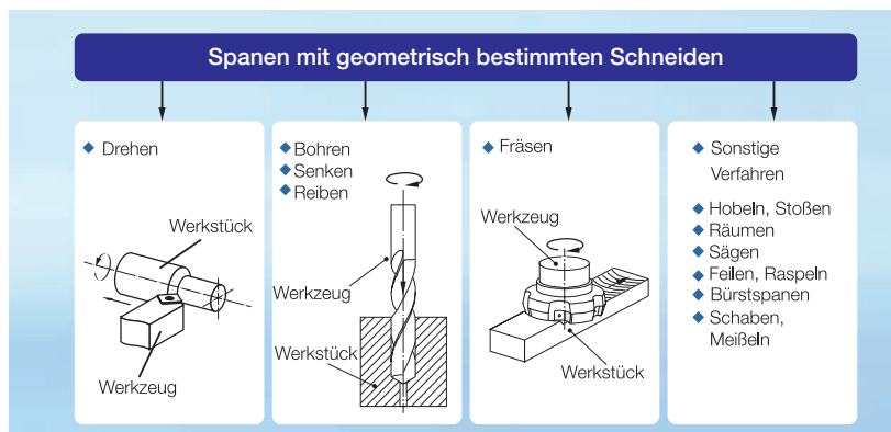
Bild 7.31: Erster Schritt der Endfertigung: Mechanische Bearbeitung bei weichem Werkstoffzustand
