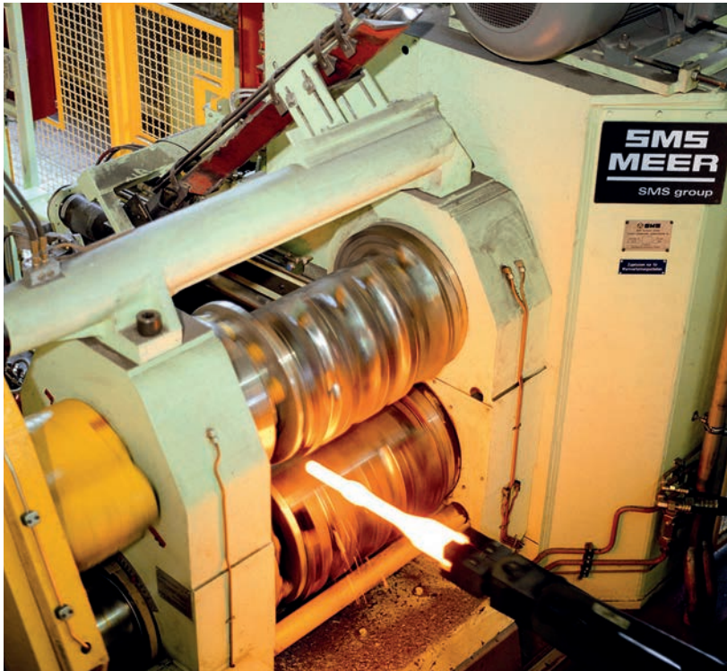
Bild 8.9: Reckwalze mit 4 Walzsegmenten
