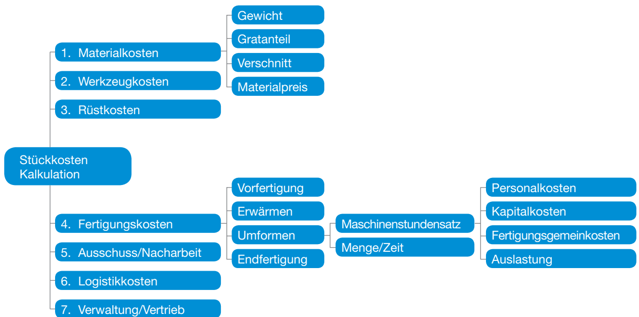
Bild 13.2: Schema einer Stückkostenkalkulation
