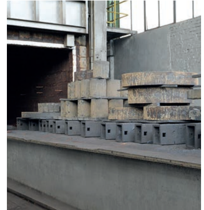
Bild 7.42: Erster Schritt der Endfertigung: Wärmebehandeln. Das Foto zeigt eine Charge wärmebehandelter Ringe vor der geöffneten Ofentüre
