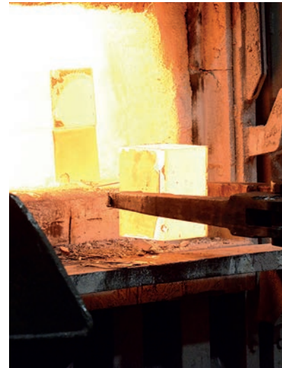
Bild 7.37: Erwärmungsprozess: Indirekte Erwärmung. Das Foto rechts zeigt die Ofenentnahme des Vorprodukts bei geöffneter Ofentür.
