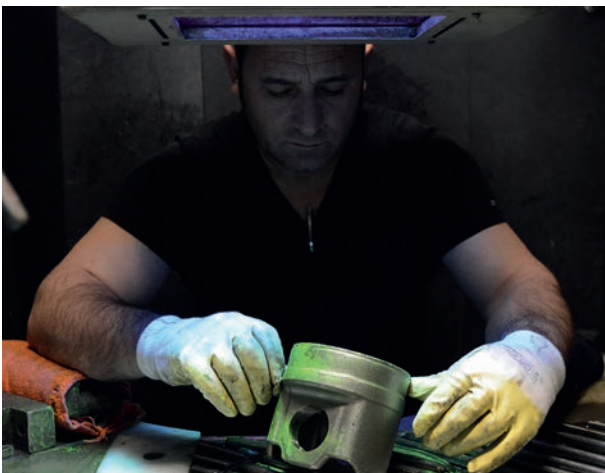
Bild 11.7: Blick in eine Fluxkabine
