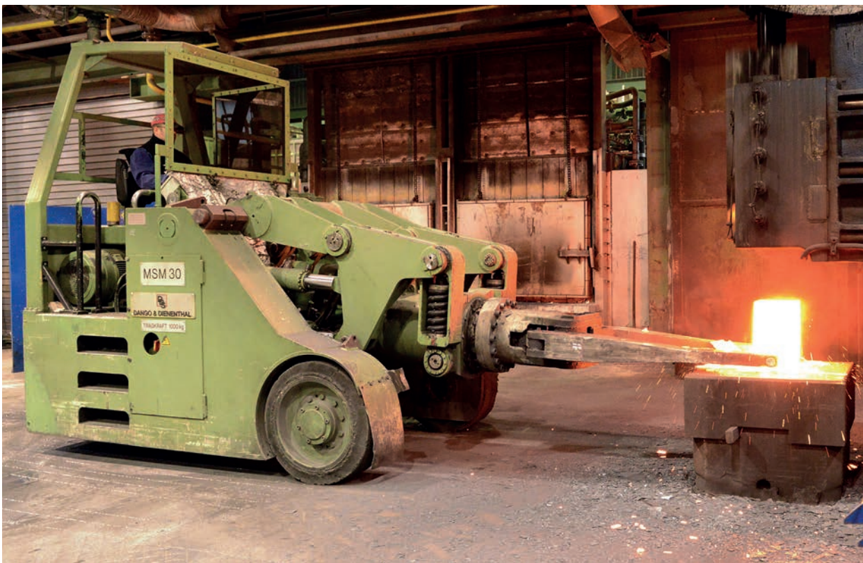
Bild 7.38: Manipulator zur Handhabung der Werkstücke
