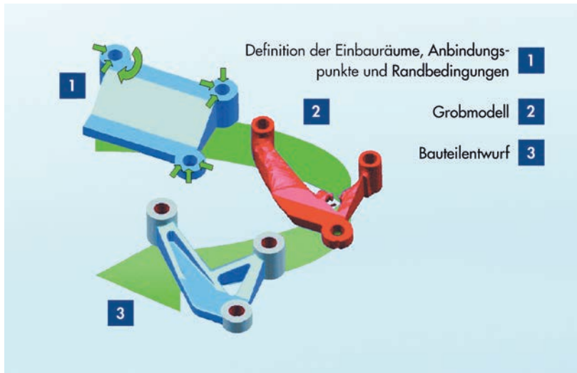
Bild 12.2: Schematischer Ablauf einer Topologieoptimierung
