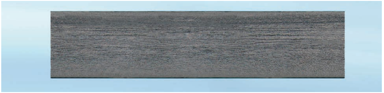
Halbzeug (Schnittdarstellung) mit ausgerichtetem Faserverlauf
