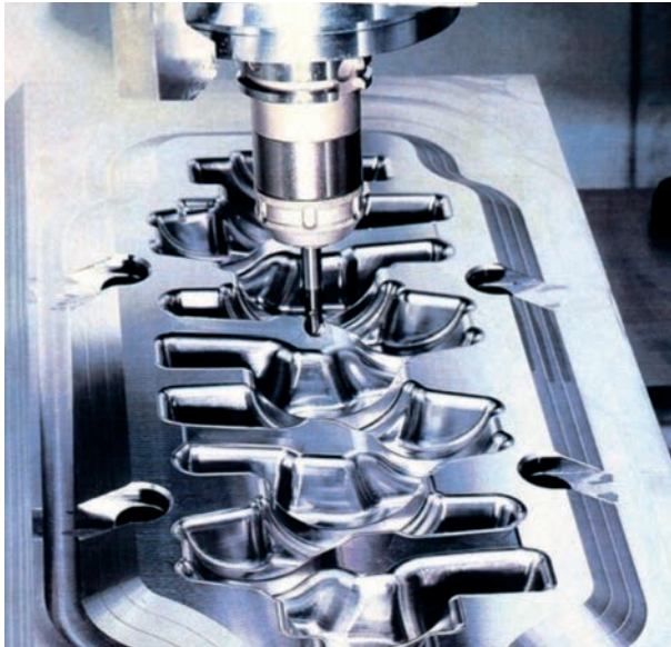
Bild 9.15: Durch HSC-Fräsen erstellte Gravur für eine Kurbelwelle
