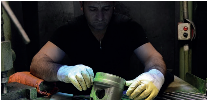
Bild 7.20: Zweiter Schritt der Endfertigung: Sichtprüfung
