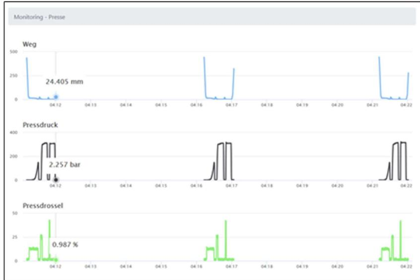
Abbildung 5.9: Darstellung ausgewählter Prozessdatenverläufe mit direkter Zuordnung der Kurven zu Bauteilidentifikationen
