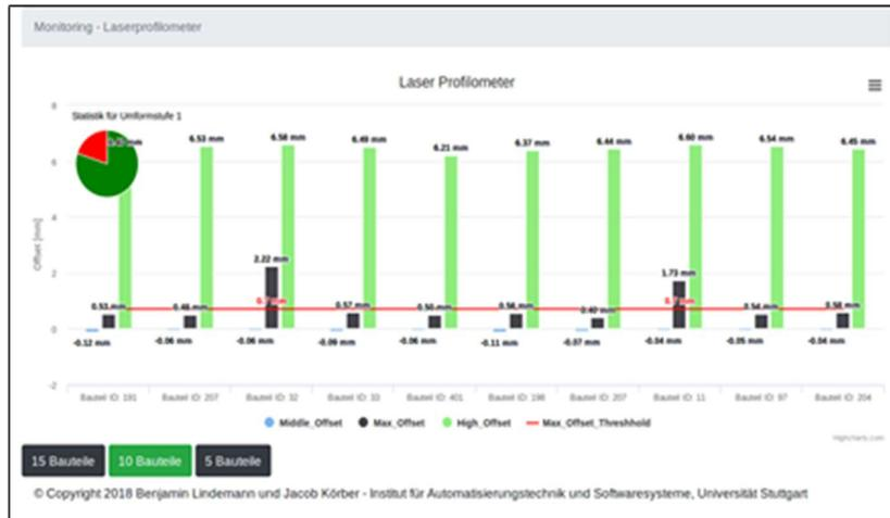
Abbildung 5.16: Darstellung der Ergebnisse zur Produktqualität der produzierten Bauteile, hier am Beispiel der Überwachung der Ausbildung von Grat
