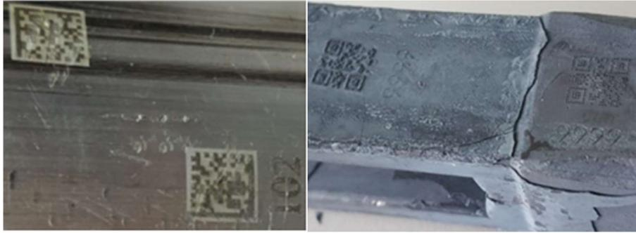
Abbildung .2.3: QR-Codes, die mit einem Faserlaser erzeugt werden: Aluminium bei 550°C, durch Kollisionen beschädigt (links); Stahl bei RT, bedeckt von einer Oxidschicht, die sich bei 900°C drei Stunden lang entwickelt (rechts). Alle Codes werden erfolgreich erkannt.
