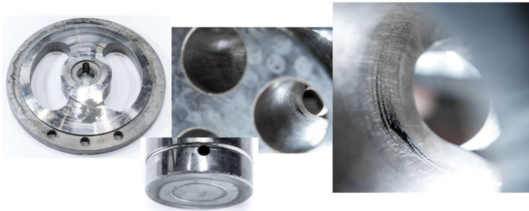
Abbildung 3.5: Schäden an Komponenten der fehlerhaften Hauptpumpe A3 nach dem Ausbau.
