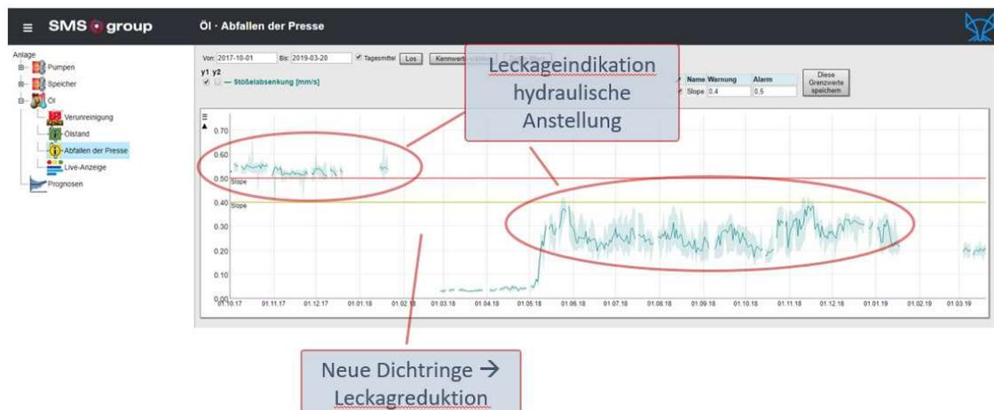
Abbildung 3.7: Kennwert für Stößel in Ruhestellung. Nach Übersteigen eines Grenzwerts vermuten Hydraulik-Techniker eine interne Leckage im Zylinder. Nach Austausch der Dichtringe sinkt der Kennwert wieder unter den Schwellwert.
