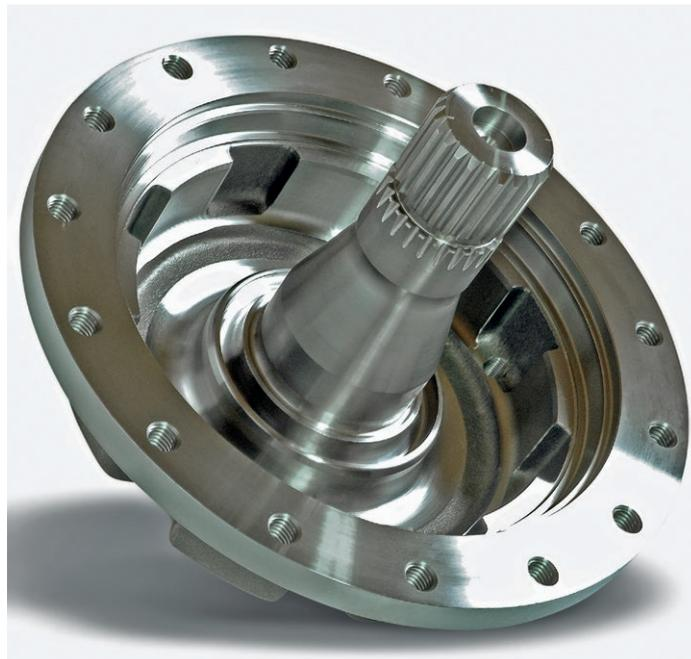
Die Vorsprünge an der Innenkontur des äußeren Kranzes werden einbaufertig geschmiedet. Im Zusammenspiel mit Blechpaketen wirken sie wie Parksperren und arretieren so bei Bedarf die Mechanik. Bilder: Hammerwerk Fridingen
