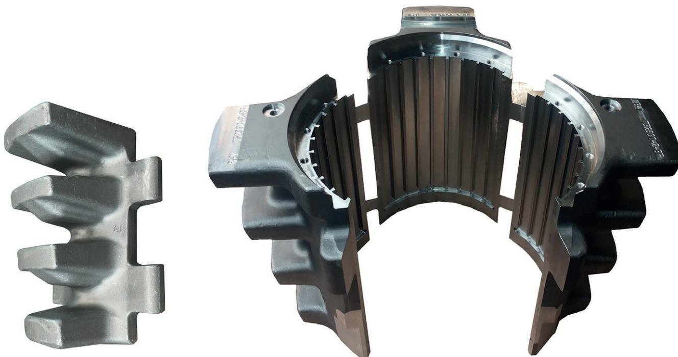
Bei diesem schmiedetechnisch äußerst anspruchsvollen Slipsegment für Offshore-Bohrtürme konnte die Haltbarkeit durch Umstellung von einer Guss- auf eine Schmiedekonstruktion um 50 bis 70 Prozent erhöht werden.
