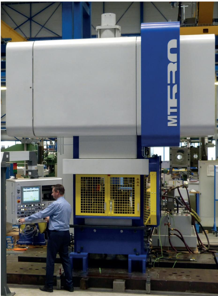
Meertorque Drive ist eine Aufteilung des Exzenterantriebs auf einen gekoppelten Beschleunigungsmotor sowie ein durch Kupplung zuschaltbares Schwungrad mit eigenem Motor. Bild: SMS Meer
