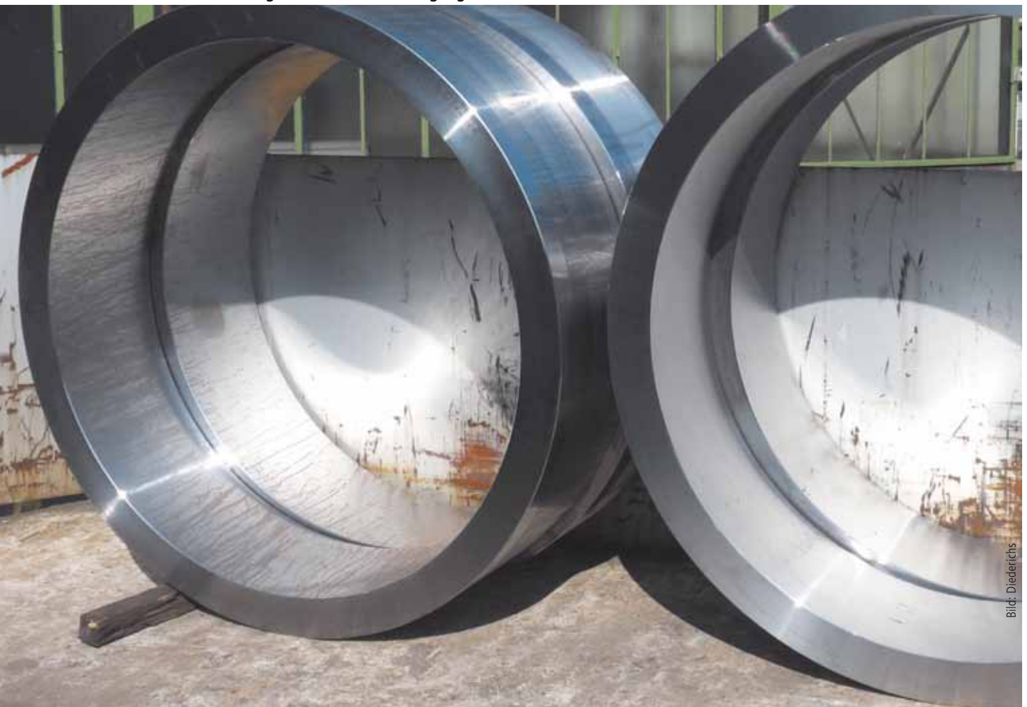
Vorbearbeitete Walzringe für die Zahradfertigung
