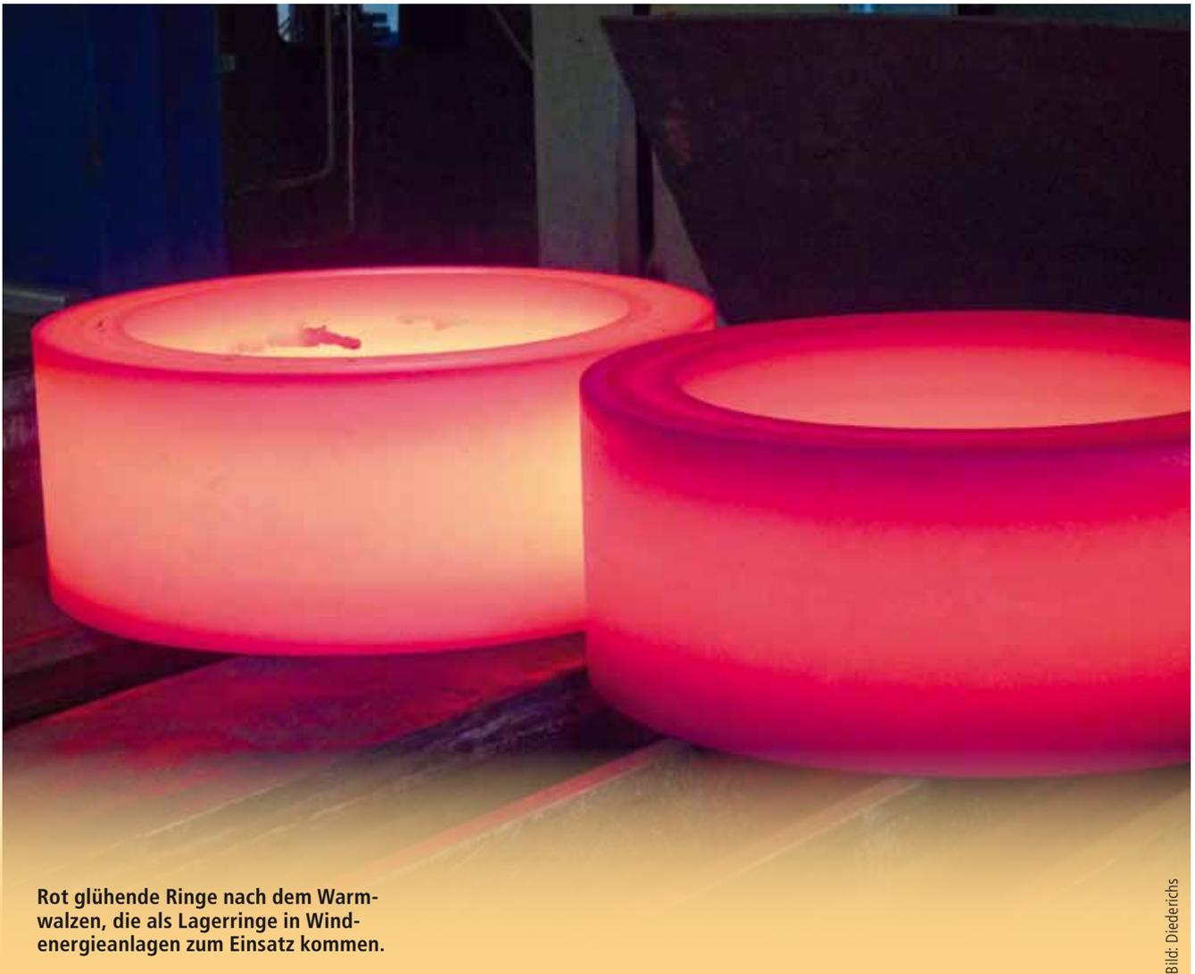
Rot glühende Ringe nach dem Warmwalzen, die als Lagerringe in Windenergieanlagen zum Einsatz kommen.
