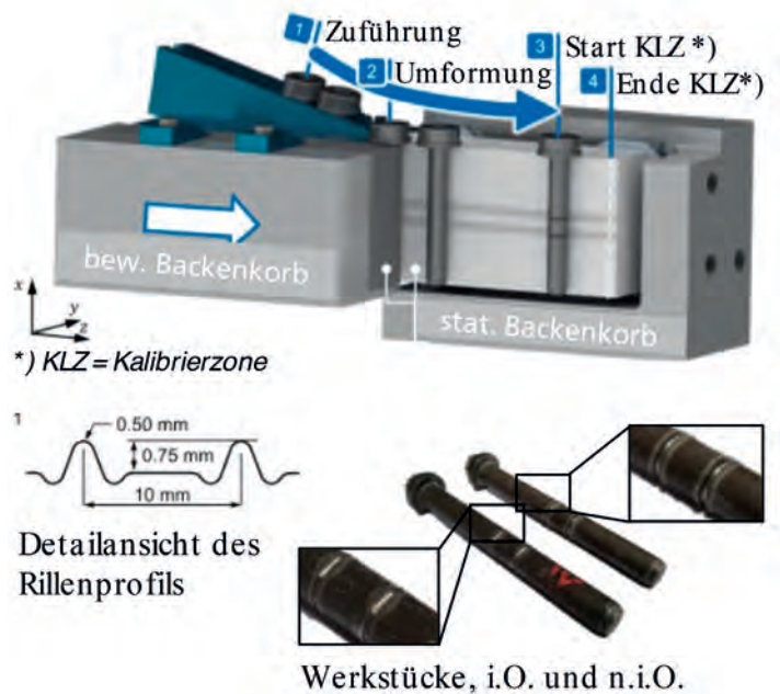
Bild 1: Versuchswerkzeug, Detailansicht des Rillenprofils sowie i.O.- und n.i.O.-Teil
