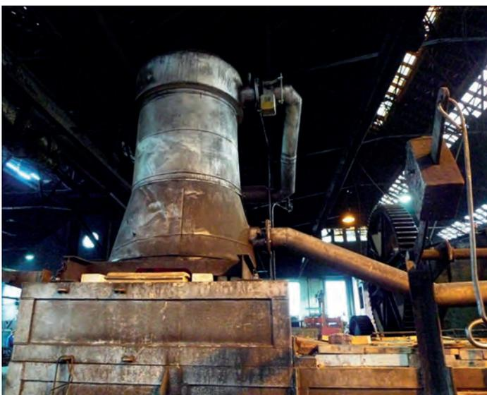
Bild 6: Defekter Zentralrekuperator
