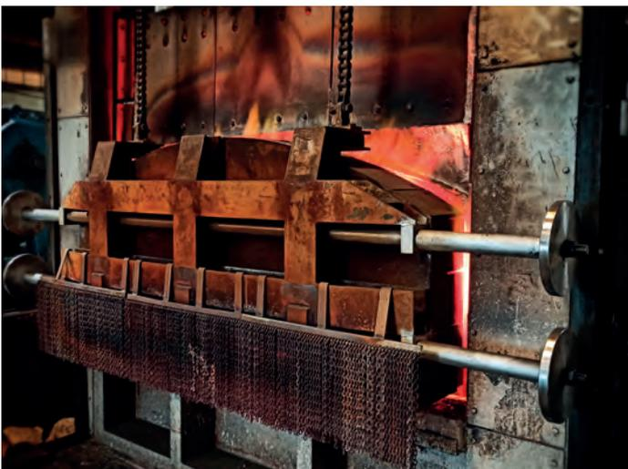
Bild 3: Undichte Tür
