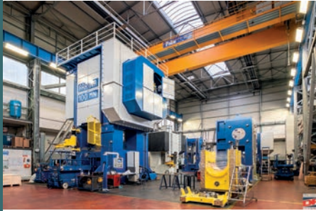
Schuler-Tochter Farina liefert eine 10.000 Tonnen starke GLF-Schmiedepresse an den Stahlring-Hersteller Molla. Bild: Schuler
