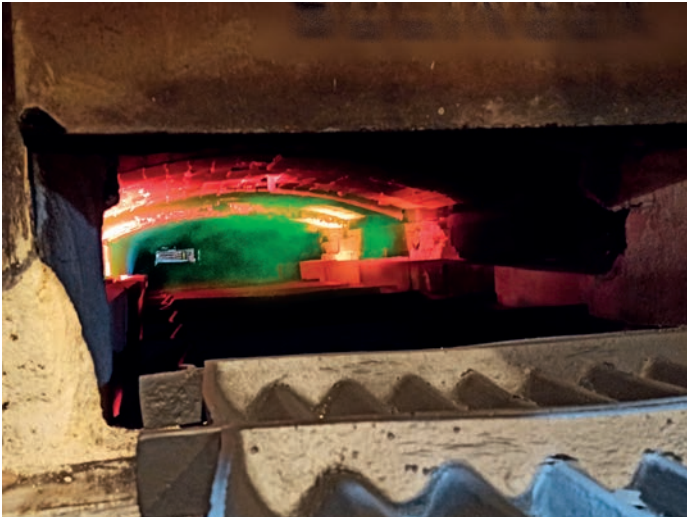
Bild 1: Grünverfärbung der Flammen durch Kohlenmonoxid
