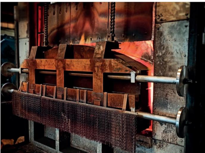
Bild 3: Undichte Tür
