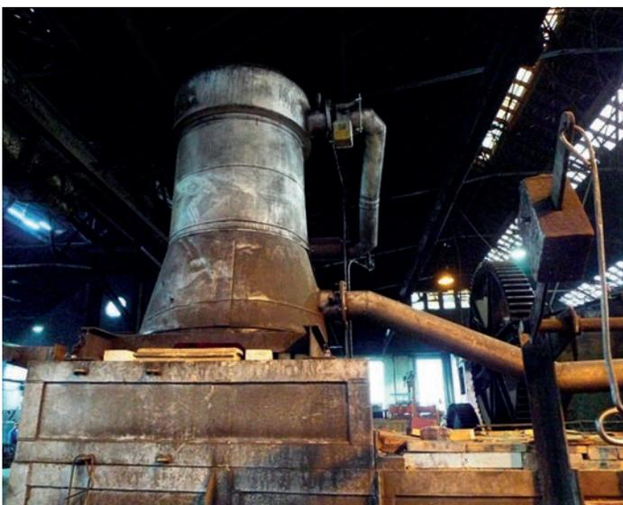
Bild 6: Defekter Zentralrekuperator
