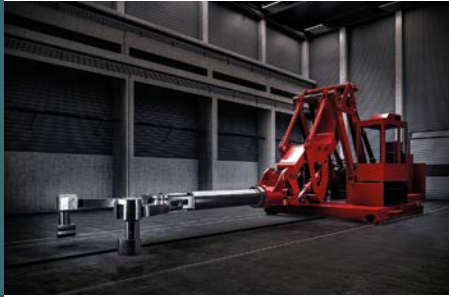
Schwerlastroboter der SLR Series von mit einer Zange für das Handling von Blöcken zwischen den Transfertischen, den Kammeröfen und der Freiformpresse.
