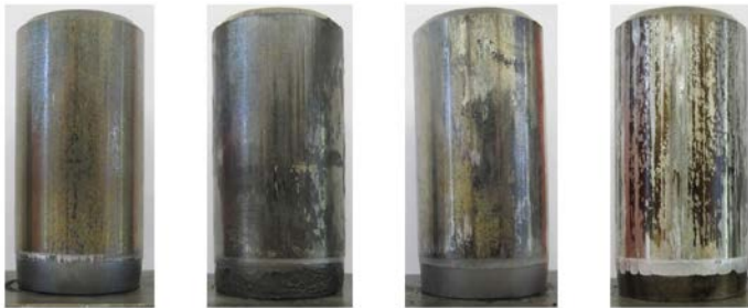
Schmierstoff 1 Schmierstoff 2 Schmierstoff 3 Schmierstoff 4 Bild 4: Verschleißmarken an den Einpressbolzen
