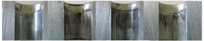
Schmierstoff 1 Schmierstoff 2 Schmierstoff 3 Schmierstoff 4 Bild 5: Verschleißmarken an den Einpresshülsen
