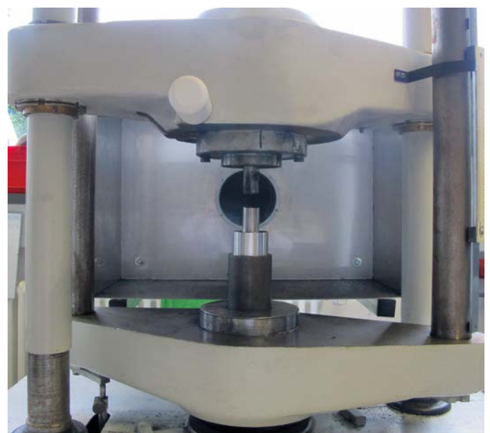
Bild 3: Aufbau des Einpresstests bei der FUCH LUBRITECH GmbH
