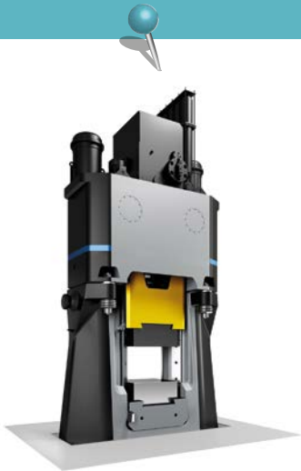
Die 36 Tonnen schwere Anlage vom Typ Bêché KGH 2,5B von Schuler ersetzt den Hammer eines Wettbewerbers, Bild: Schuler
