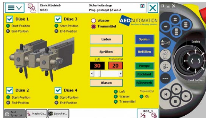
Bild 6: Bedienoberfläche, Bilder 3 bis 6: AED Automation
