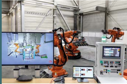
Virtuelle Inbetriebnahme für die Hirschvogel Umformtechnik GmbH
