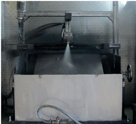
Bild 1: Sprühstand für den Benetzungstest
