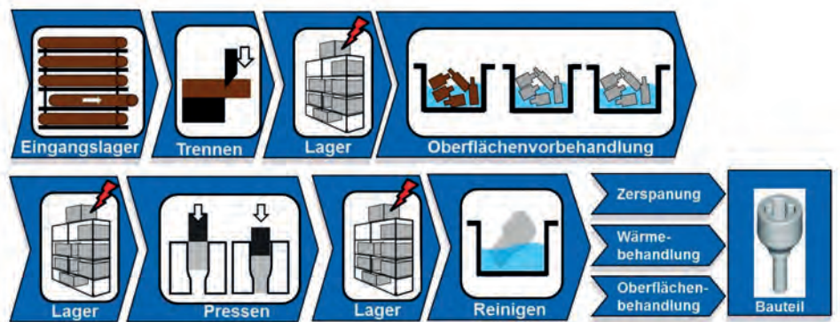
Bild 1: Prozesskette in der Kaltmassivumformung
