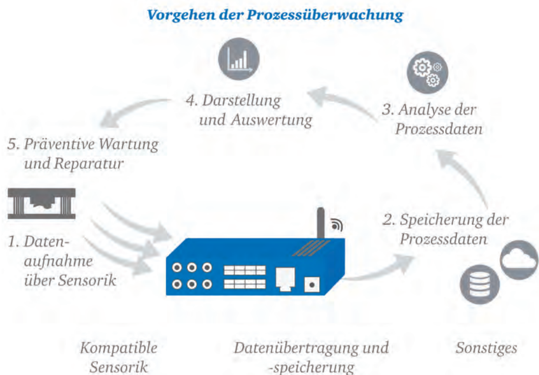
Bild 2: Mittels Datenanalyse werden aus gesammelten Sensordaten präventive Wartungen und Reparaturen prognostiziert
