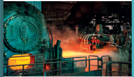
Wasserhydraulisches Entzunderungssystem von Hauhinco in der Stahlproduktion
