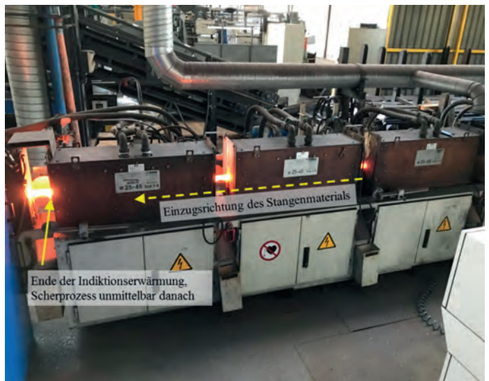
Bild 1: Induktionserwärmungsanlage mit vier Spulen vor einer Warm Schmiedepresse
