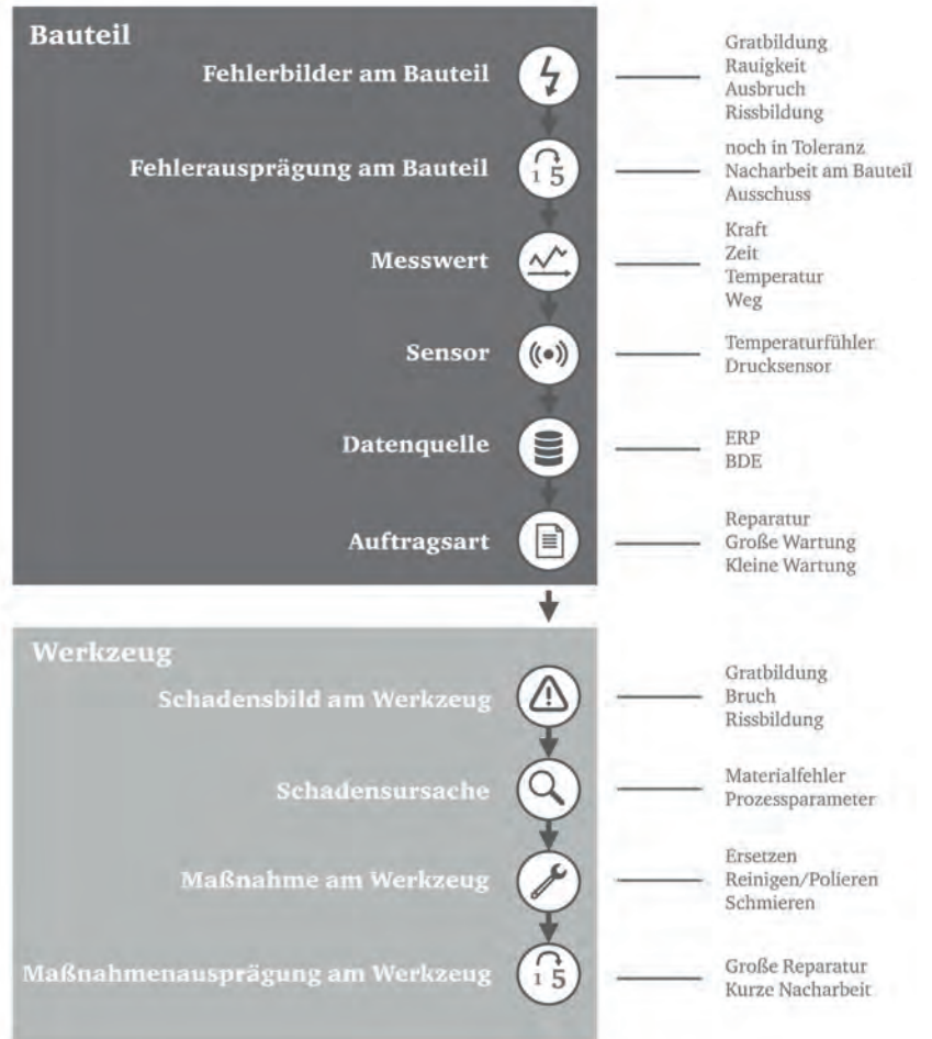
Bild 1: Die Zusammenstellung der Wirkzusammenhänge von Bauteil- und Werkzeugfehlern in der Massivumformung sind relevant für die Ableitung einer Prognosesystematik.
