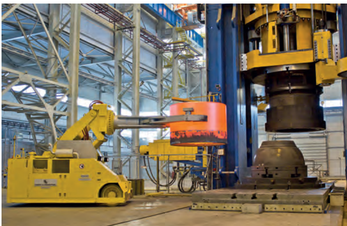
Bild 1: Mehrere Transportmanipulatoren sind bereits mit Telemetrieboxen ausgestattet worden
