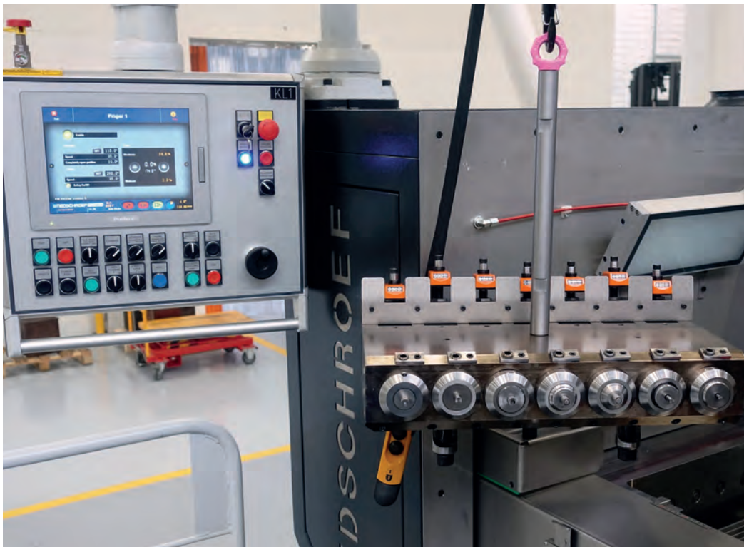
Bild 3: Wechsel eines voreingestellten Stempelblocks mit integrierten Stellkeilen Bilder: Autoren
