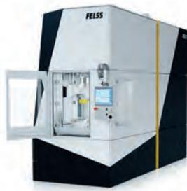
Neue Felss Axialformmaschine AxFORM F
