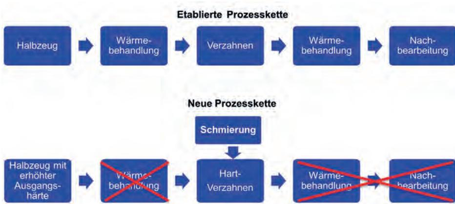
Bild 1: Etablierte Prozesskette und optimierte Prozesskette
