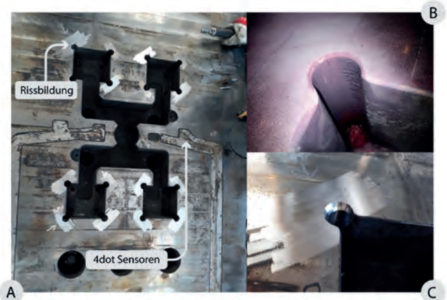
Bild 3: Inspektion eines defekten Gesenkhalters: Risse entstehen üblicherweise an Aussparungen für Auswerfer oder Auswerferbrücken (A); Rissanzeige durch Sicht- und Farbeindringprüfung (B); verschliffener Riss (C)
