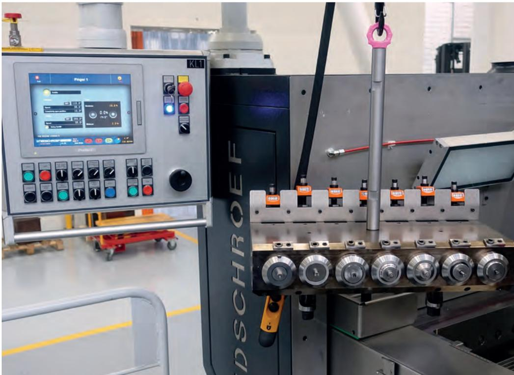
Bild 3: Wechsel eines voreingestellten Stempelblocks mit integrierten Stellkeilen
