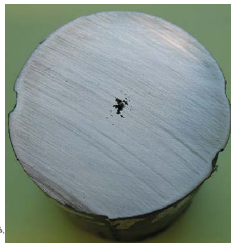
Bild 5: Gegenüberstellung der Ergebnisse von Simulationsmodell und Warmumformung beim Walzvorgang mit ebenen Werkzeugen (links: Simulationsmodell, rechts: Kernaufreißung beim Walzversuch nach acht Überrollungen)
