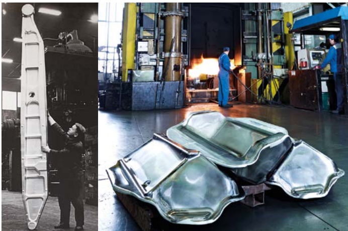
Bild 3: Fahrwerksträger der Boeing 727 (links) und 300 MN-Pressen (rechts)
