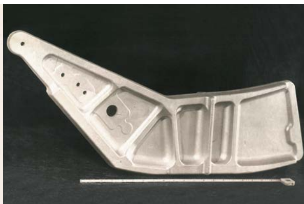
Bild 1: Differenzialbauweise und Integral-Schmiedeteil [2]
