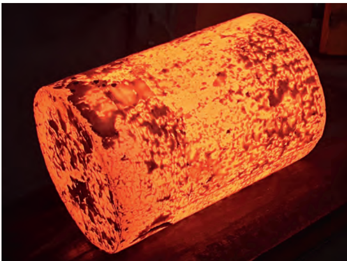
Bild 1: Verzunderungen ändern die Strahlungseigenschaften eines Blocks erheblich
