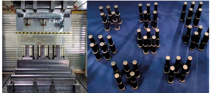
Bild 3: Versuchsaufbau zur Herstellung skaliertener Getriebewellen durch Voll-Vorwärts-Fließpressen (links) und erzeugte Wellen (rechts)
