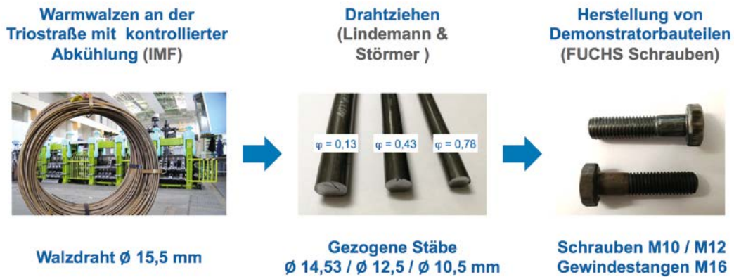
Bild 1: Semiindustrielle Herstellungsrouten der Demonstratorbauteile
