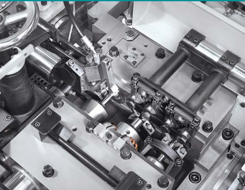
Schnell, flexibel, präzise: Auf der HOTmatic AMP 20 N lassen sich nahezu alle handelsüblichen Nockengrößen herstellen
