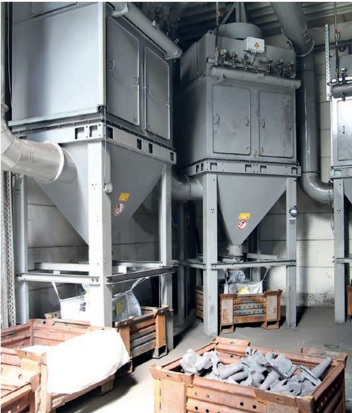
Bild 3: Die Absauganlagen sind große Druckluftverbraucher
