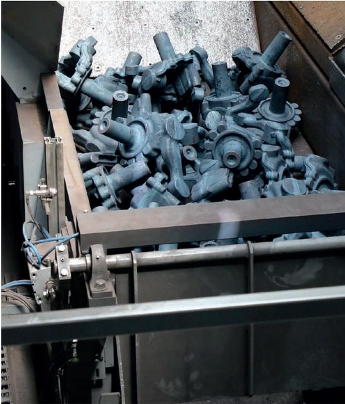
Bild 5: Die Schmiedeteile kurz vor der Einfahrt in die Sandstrahlanlage. Im Vordergrund sind die blauen Druckluftschläuche zu sehen, über die die Betätigungszyylinder für die Zuführklappe mit Luft versorgt werden
