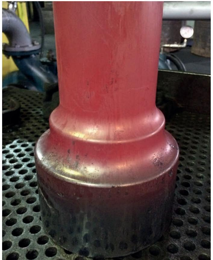
Bild 1: Hohlachse nach der Warmumformung
