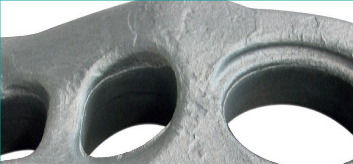
Im Produktionsbereich von Entzunderungsanlagen wurden Microline Descaling-Systeme speziell für induktiv erwärmte Schmiedeteile mit einem Gewicht von etwa 5 bis 20 kg auf den Markt gebracht. Die Systeme erzielen nicht nur saubere Werkstückoberflächen, sondern eröffnen darüber hinaus mit minimalem Temperaturabfall sowie geringem Wasser- und Energiebedarf neue Möglichkeiten der effizienten Herstellung hochwertiger Schmiedeteile.
