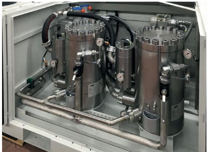
Bild 5: An der zentralen Druckversorgung des MF-Systems können mehrere Entzunderungslinien betrieben werden
