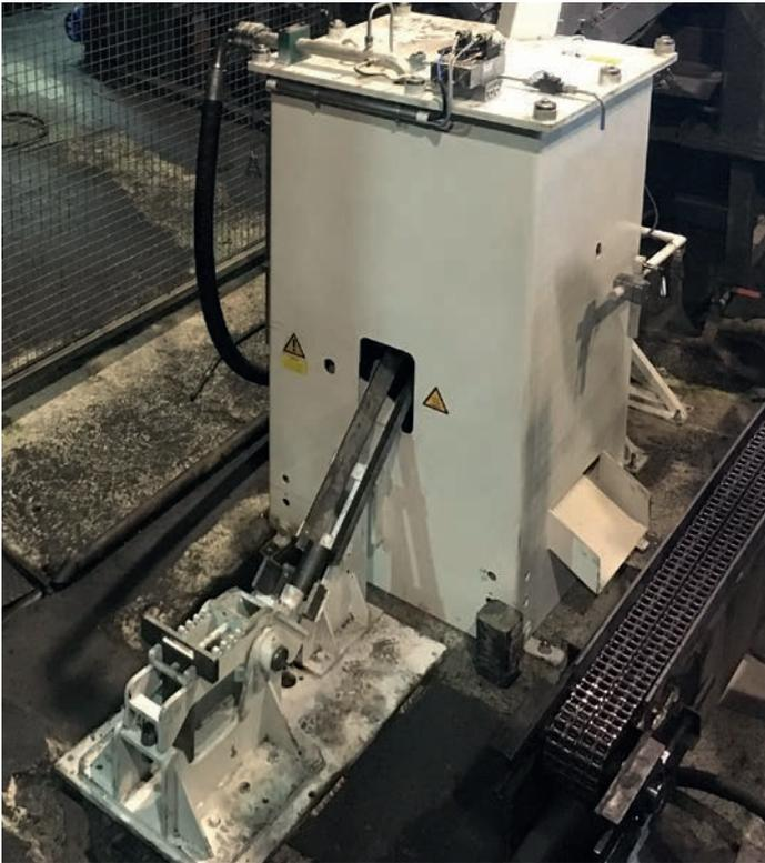
Bild 2: Microline-Descaling System für die Entzunderung von Schmiedeteilen für die Automobilindustrie
