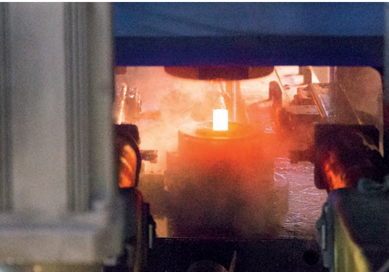
Bild 2: MT-Gesenkschmiedepresse während der Produktion von Differenzialkegelrädern Bilder: SMS group GmbH
