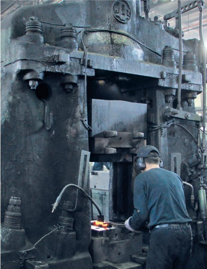
Bild 6: Fertigschmieden der Hüftimplantate im Oberdruckhammer beim Schmiedeunternehmen
