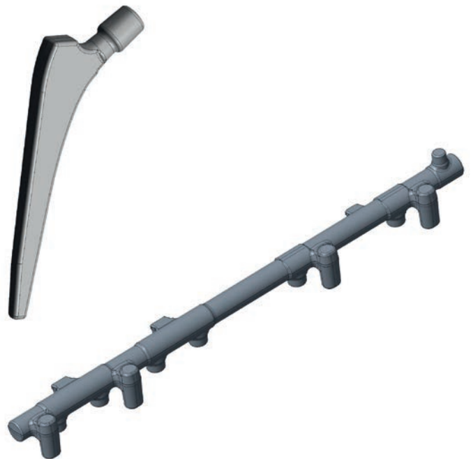
Bild 1: Demonstratorbauteile: Hüftimplantat (L = 162 mm) aus dem Titan Ti6AlV4 (links), Common-Rail (L = 728 mm) aus bainitischem Stahl (rechts)
