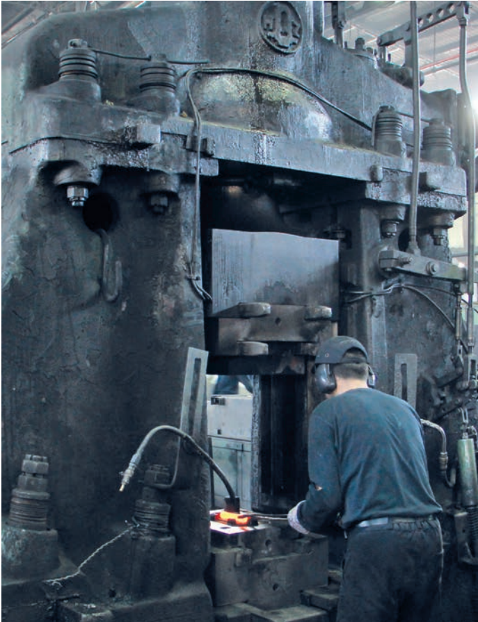
Bild 6: Fertigschmieden der Hüftimplantate im Oberdruckhammer beim Schmiedeunternehmen Bilder: Autoren
