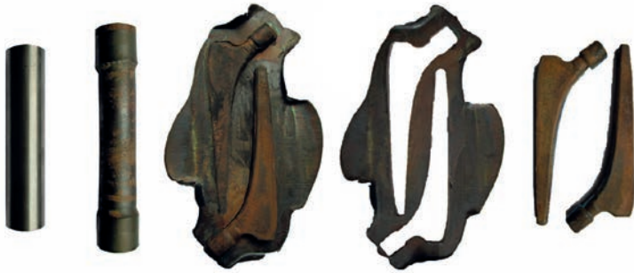
Bild 4: Stadienfolge der erfolgreich gewalzten Vorform und fertig geschmiedeten Hüftimplantate
