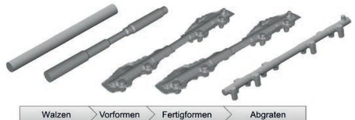
Bild 3: Modelle der ressourceneffizienten Stadienfolgen für das Hüftimplantat (links) und das Common-Rail (rechts)
