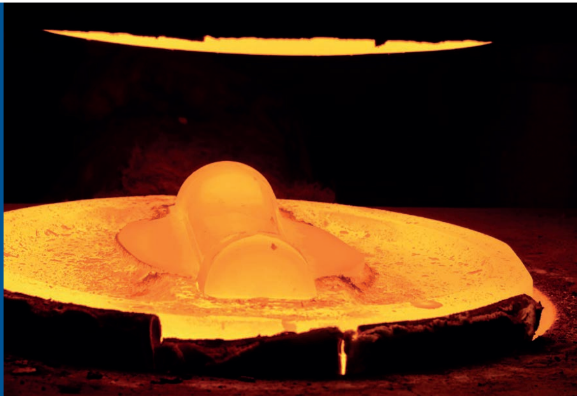
Bild 5: Geschmiedete Schaufel im Gesenk Bilder 2-5: Autor
