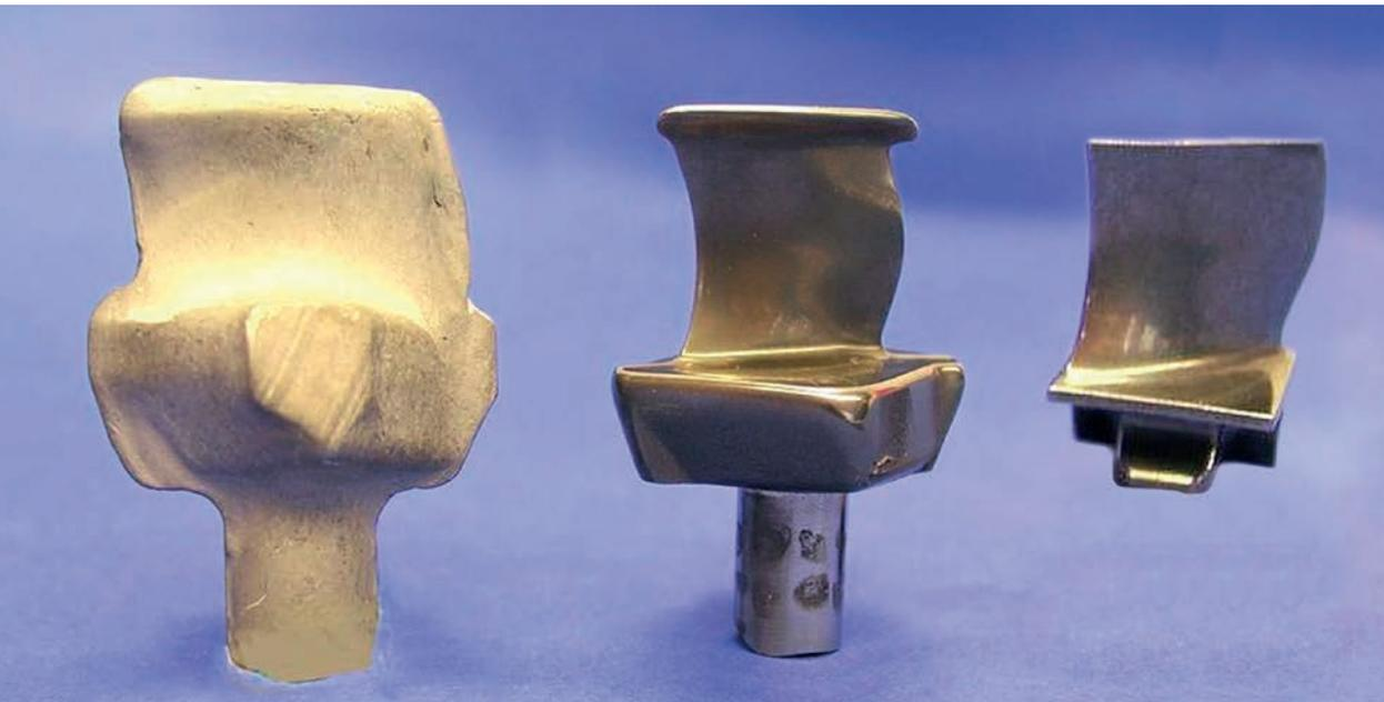
Bild 4: Fertigungsfolge
