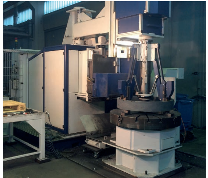
Bild 6: Prototyp GRC2000-500CNC, der am Standort für Lohntrennarbeiten eingesetzt wird
