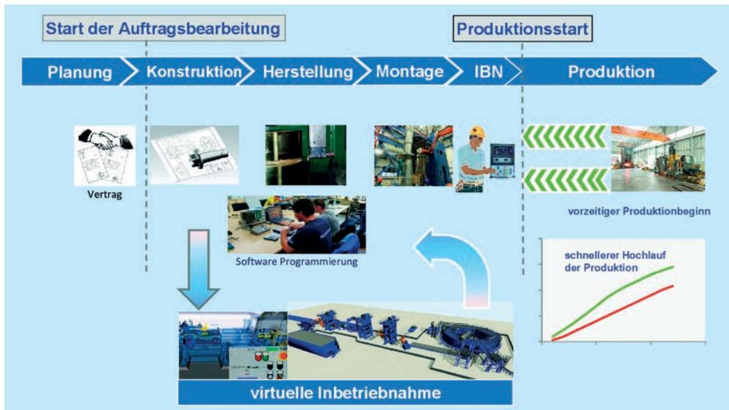
Bild 2: Auftragsbearbeitung mit VIBN
