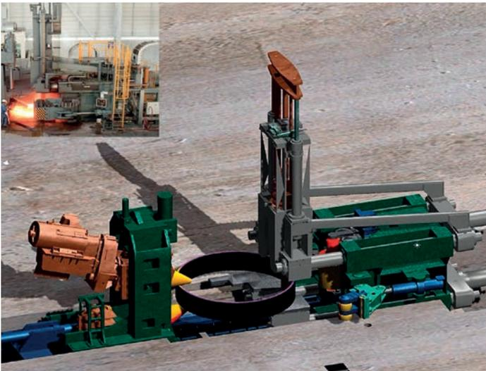
Bild 6: 3D-Modell der Ringwalzmaschine RAW
