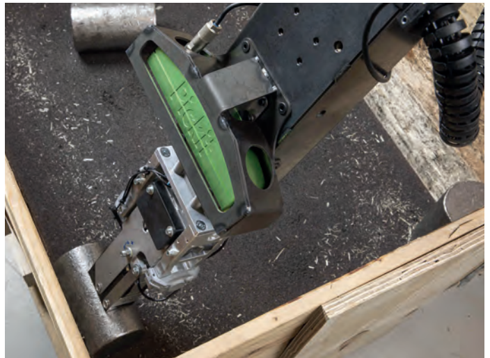
Der Billet Picker kann verdeckte Zylinderrohlinge oder Teile in der Nähe einer Behälterwand entnehmen.
