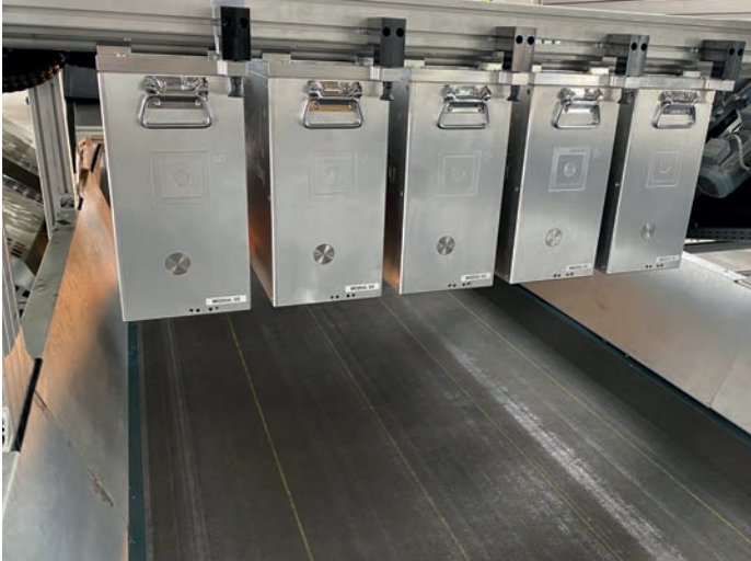
Bild 2: Fünf parallel arbeitende clean2sort LIBS-Messmodule (Förderbreite 1,2 m)
