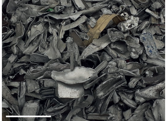
Bild 3: Geschredderter und gesiebter Al-EoL-Schrott. Der weiße Balken entspricht 10 cm
