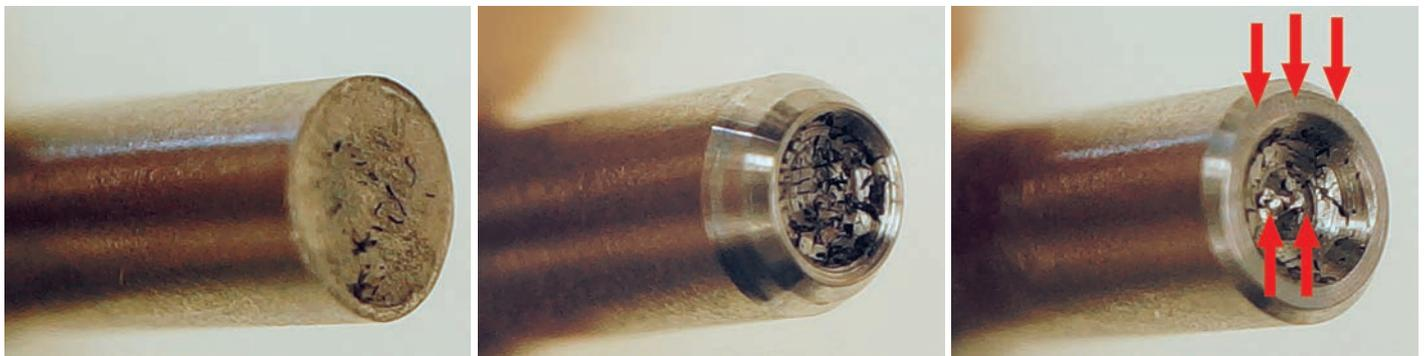
Bild 1: Typisches Fehlerbild beim Kuppvorgang, links: Rohling, mittig: Gutteil, rechts: Fehlteil
