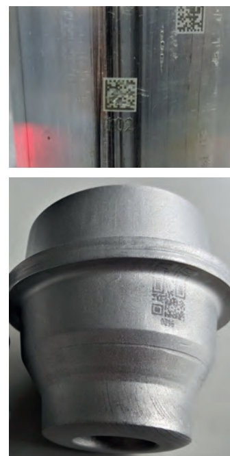
Bild 3: Mit einem Faserlaser erzeugte, lesbare QR-Codes auf der Werkstückoberfläche vor der induktiven Erwärmung beschriftet (oben) sowie bei 500 °C geschmiedet und sandgestrahlt nach dem Abkühlen (unten).
