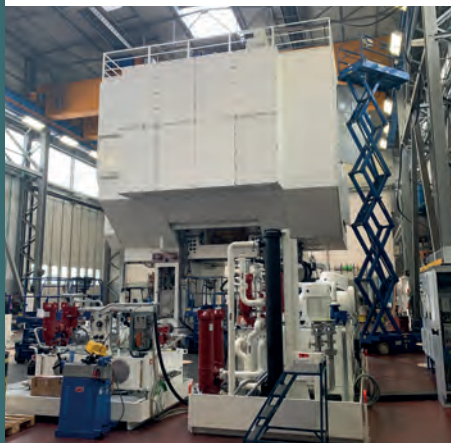
Die Farina-Anlagen der Baureihe GLF verfügen über ein neuartiges direktes Antriebskonzept ohne Pleuel. Bild: Schuler
