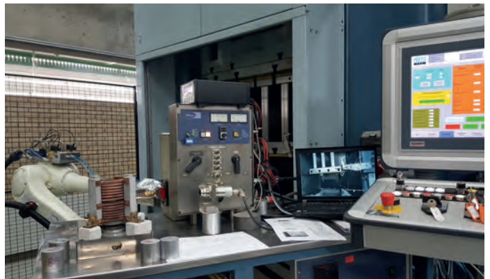
Bild 1: Vollautomatisierte Modellanlage für das Gesenkschmieden von Aluminium am IFU Stuttgart
