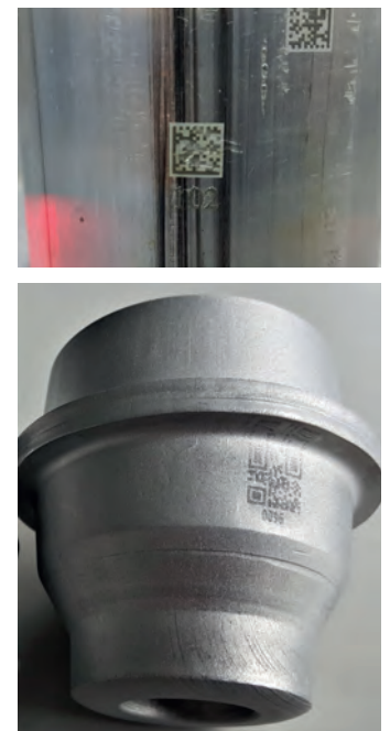
Bild 3: Mit einem Faserlaser erzeugte, lesbare QR-Codes auf der Werkstückoberfläche vor der induktiven Erwärmung beschriftet (oben) sowie bei 500 °C geschmiedet und sandgestrahlt nach dem Abkühlen (unten).
