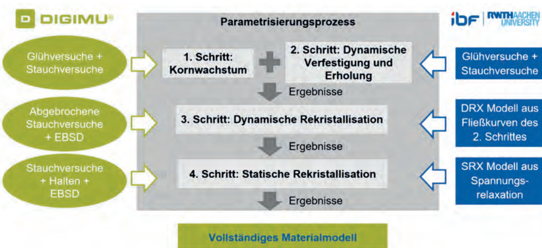
Bild 2: Charakterisierungs- und Parametrisierungsprozess in DIGIMU® (links) und angepasst durch das IBF (rechts)
