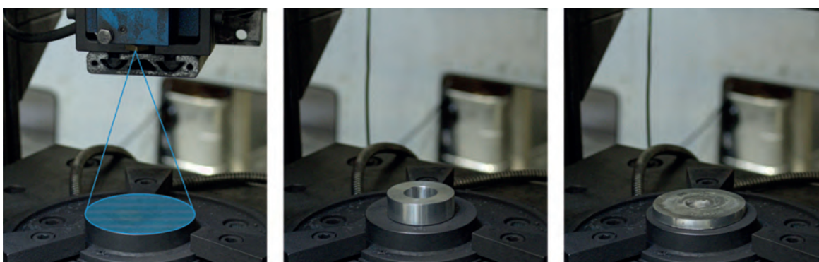
Bild 3: Ringstauchversuch mit Sprühfeld beim IFUM [3]
