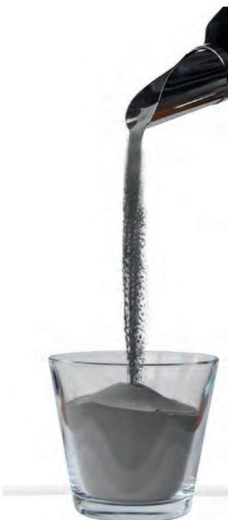
Bild 3: Das feinkörnige Metallpulver für das SLM-Verfahren weist eine Partikelgrößenverteilung zwischen 10 und 60 µm auf
