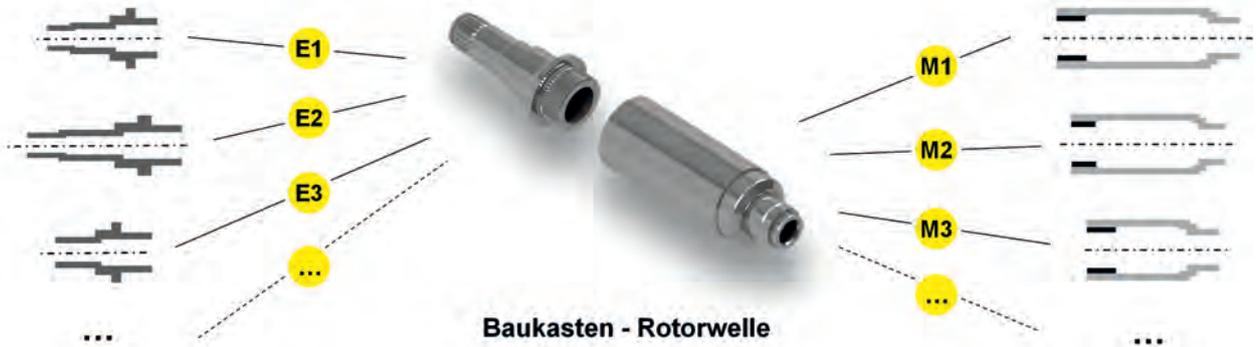
Bild 1: Grundlegender Aufbau einer segmentierten Rotorwelle [2]
