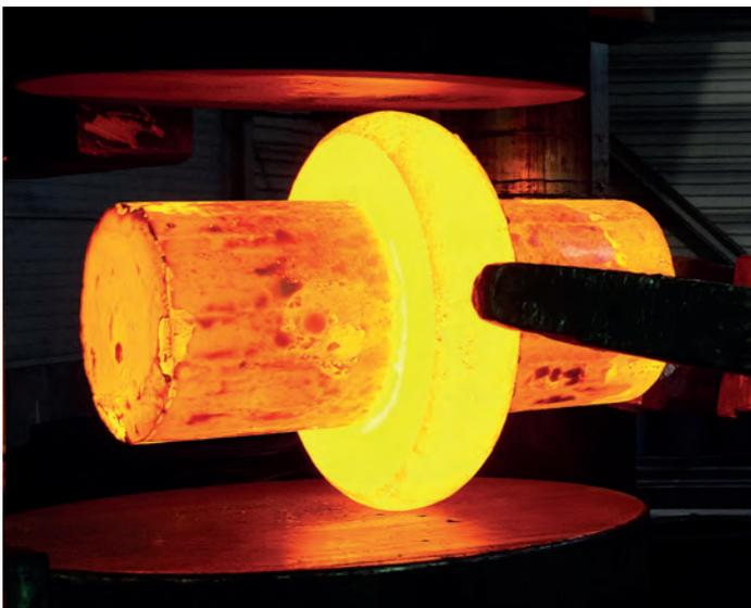
Bild 1: Komplexe, hochbelastbare Bauteile bis 4,5 Tonnen Stückgewicht werden aus über 400 verschiedenen Werkstoffen geschmiedet
