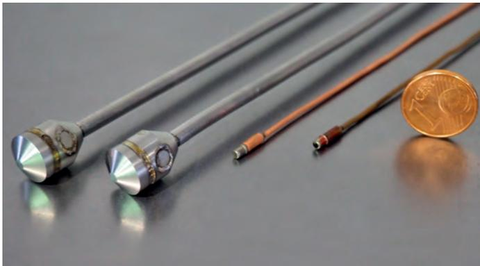
Bild 3: Transponder in verschiedenen Ausführungen
