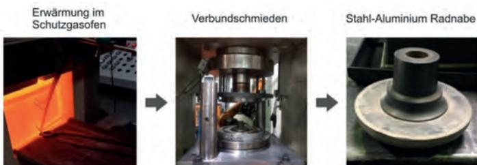
Bild 4: Ablauf zum Verbundschmieden hybrider Radnaben [3]
