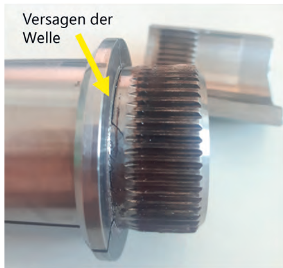
Bild 6: Verzahnungsbereich eines nach Versagen bei 2133 Nm aufgetrennten Probekörpers
