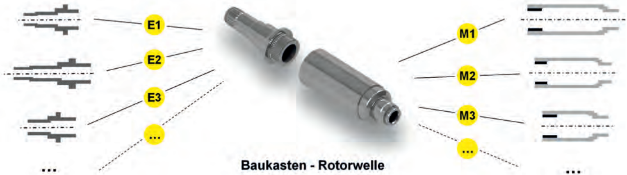
Bild 1: Grundlegender Aufbau einer segmentierten Rotorwelle [2]
