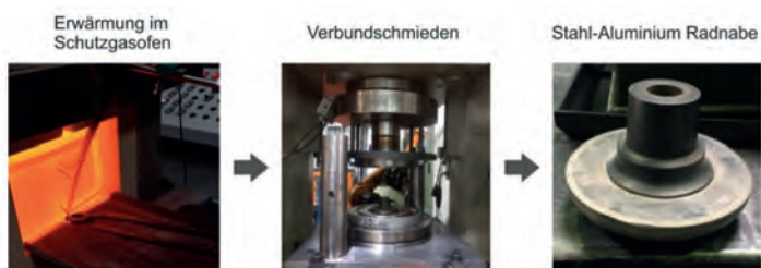
Bild 4: Ablauf zum Verbundschmieden hybrider Radnaben [3]
