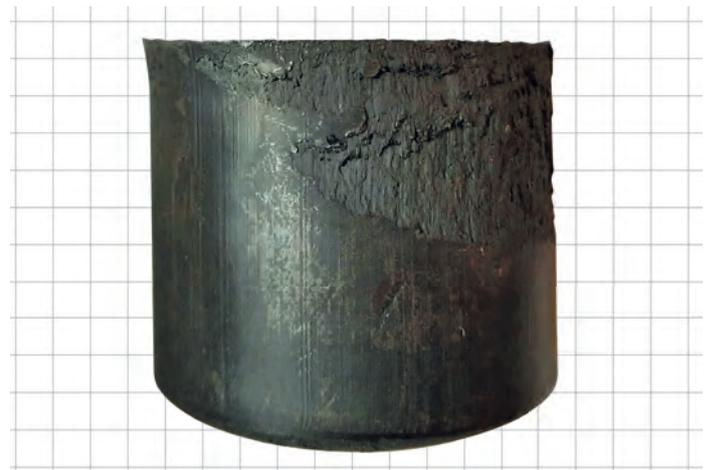
Bild 3: Abrissverlauf an einem Butzen
