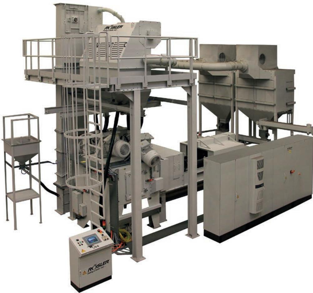
Bild 1: Die für das komplett vollautomatische Strahlen unterschiedlicher Kurbelwellen konzipierte RKWS 2x2 benötigt kein Fundament
